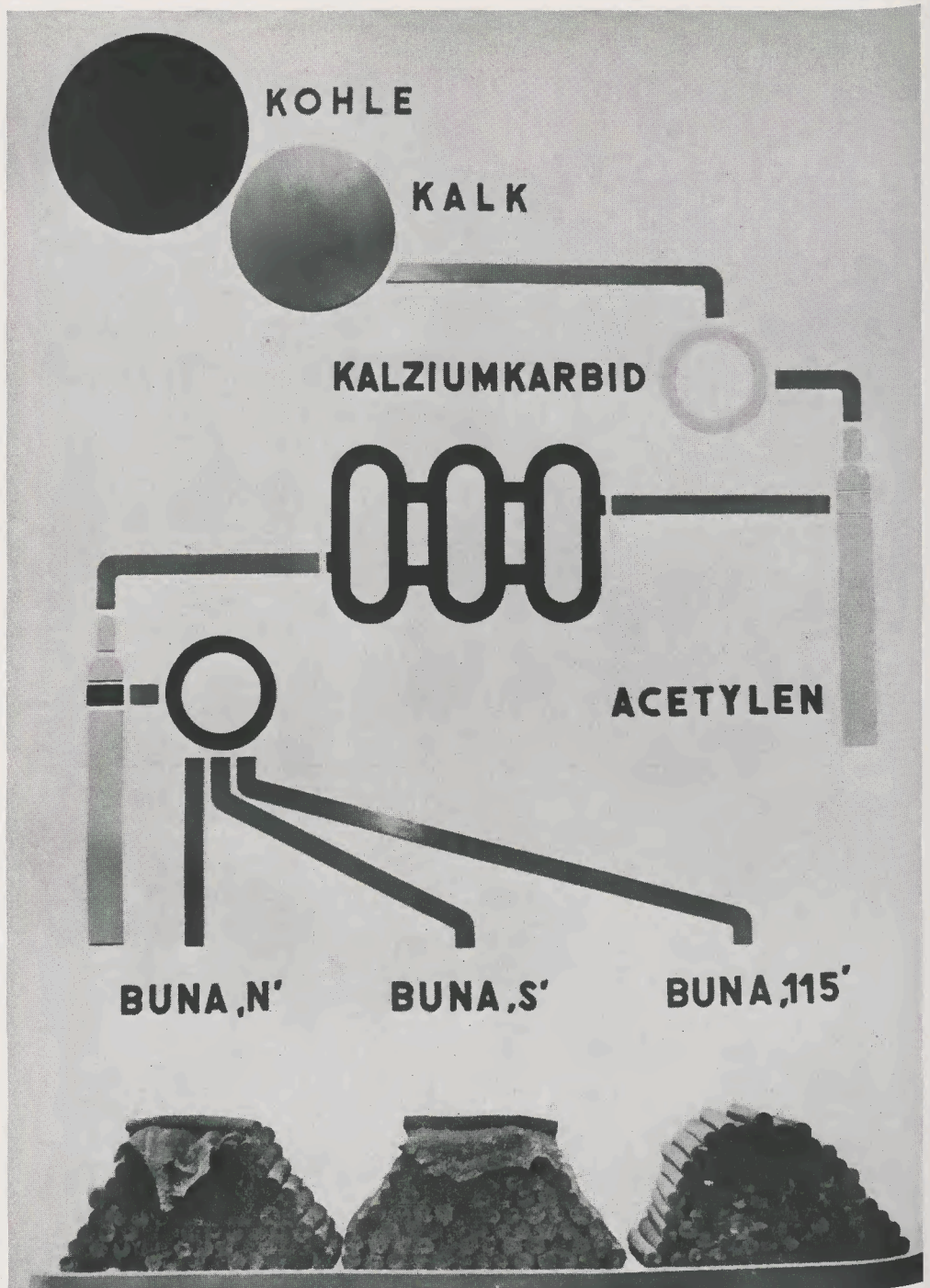
Schema der Herstellung von synthetischem Gummi (Buna)
